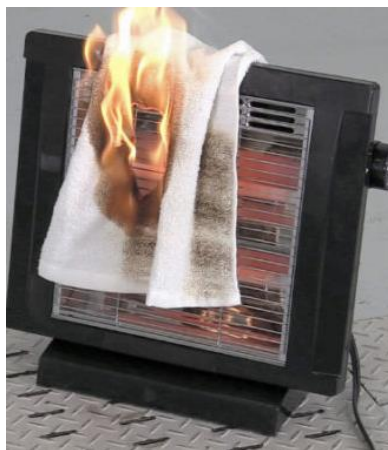
Figura 1: Foco de incêndio gerado pelo mau uso de um aquecedor halógeno
